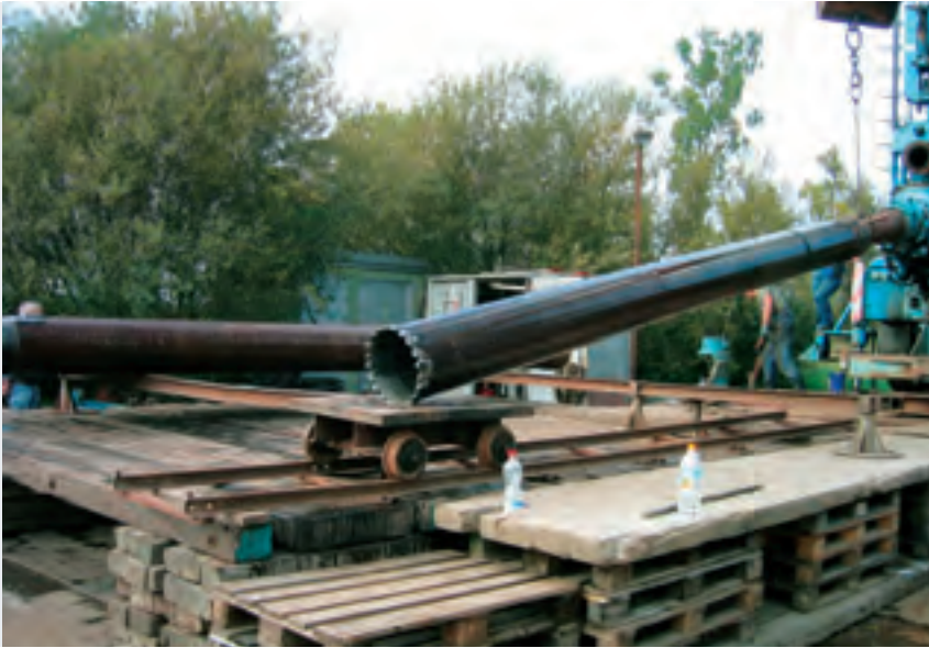
◁ Abb. 4 Überbohrrohr 368 mm mit Überbohrkrone 400 mm
