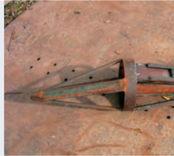
◁ Abb. 4 Überbohrrohr 368 mm mit Überbohrkrone 400 mm
