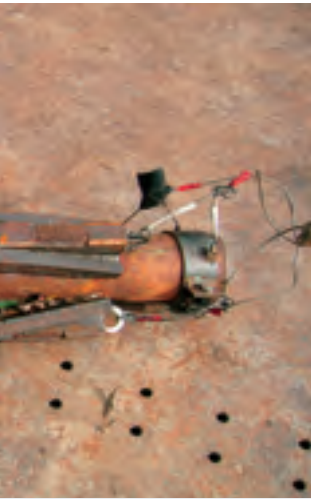
◀ Abb. 5 Keilfänger zum Fangen der überbohrten Aufsatzrohre DN 250
