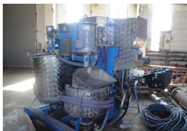
Bild 3: Verpressstation der Fa. Obermann
