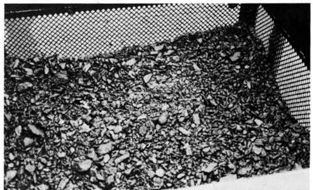
4 Im Siebkasten aufgefangene grobstückige Kohle
