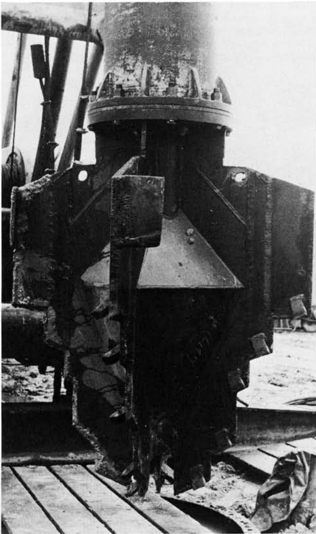
2 Kastenmeißel (Ø 1,5 m), besetzt mit Reißzähnen
