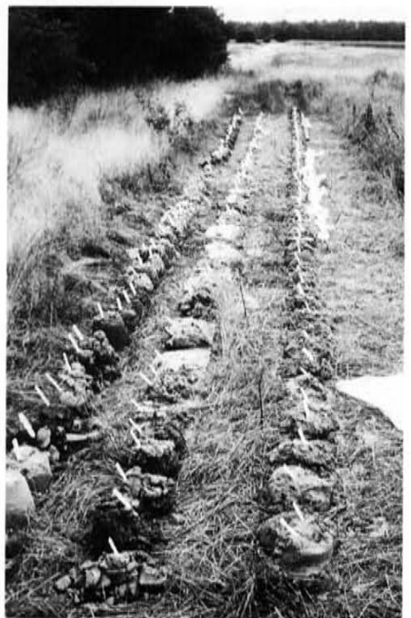
1 Ausgelegte Bodenproben mit Teufenangabe
